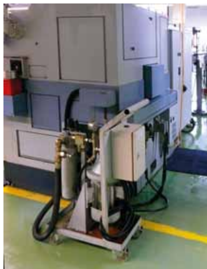
Bild 3: Die kompakte und mobile Hochdruck-Anlage SFB-100 Smart erlaubt Jörg Geigle einen flexiblen Einsatz an wechselnden Drehautomaten
